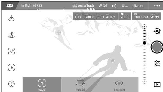
4. A aeronave automaticamente irá evitar obstáculos no percurso de voo. Se a aeronave perder o rastro do objeto porque ele se move muito rápido ou ficou oculto, selecione o objeto novamente para retomar o rastreamento.
